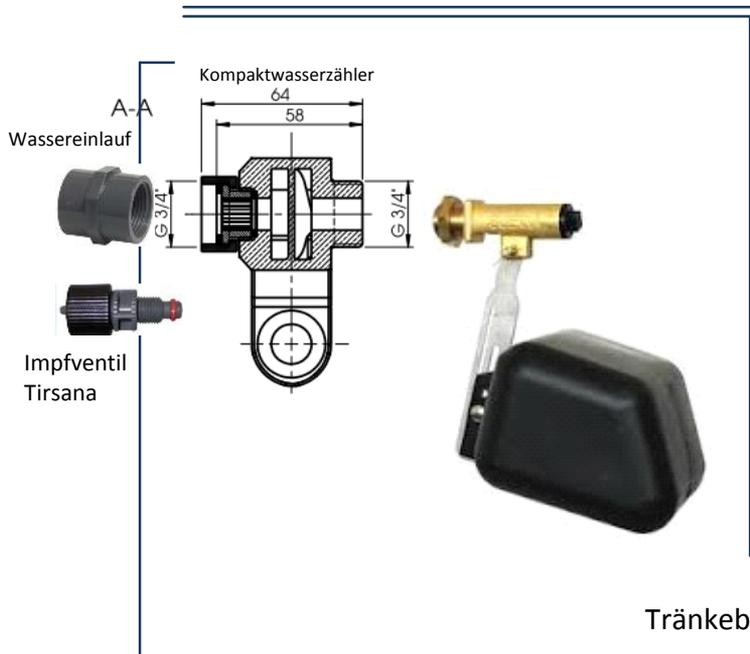
Der neue Kompaktwasserzähler wird zwischen Wassereinlauf und Schwimmerventil eingebaut.
