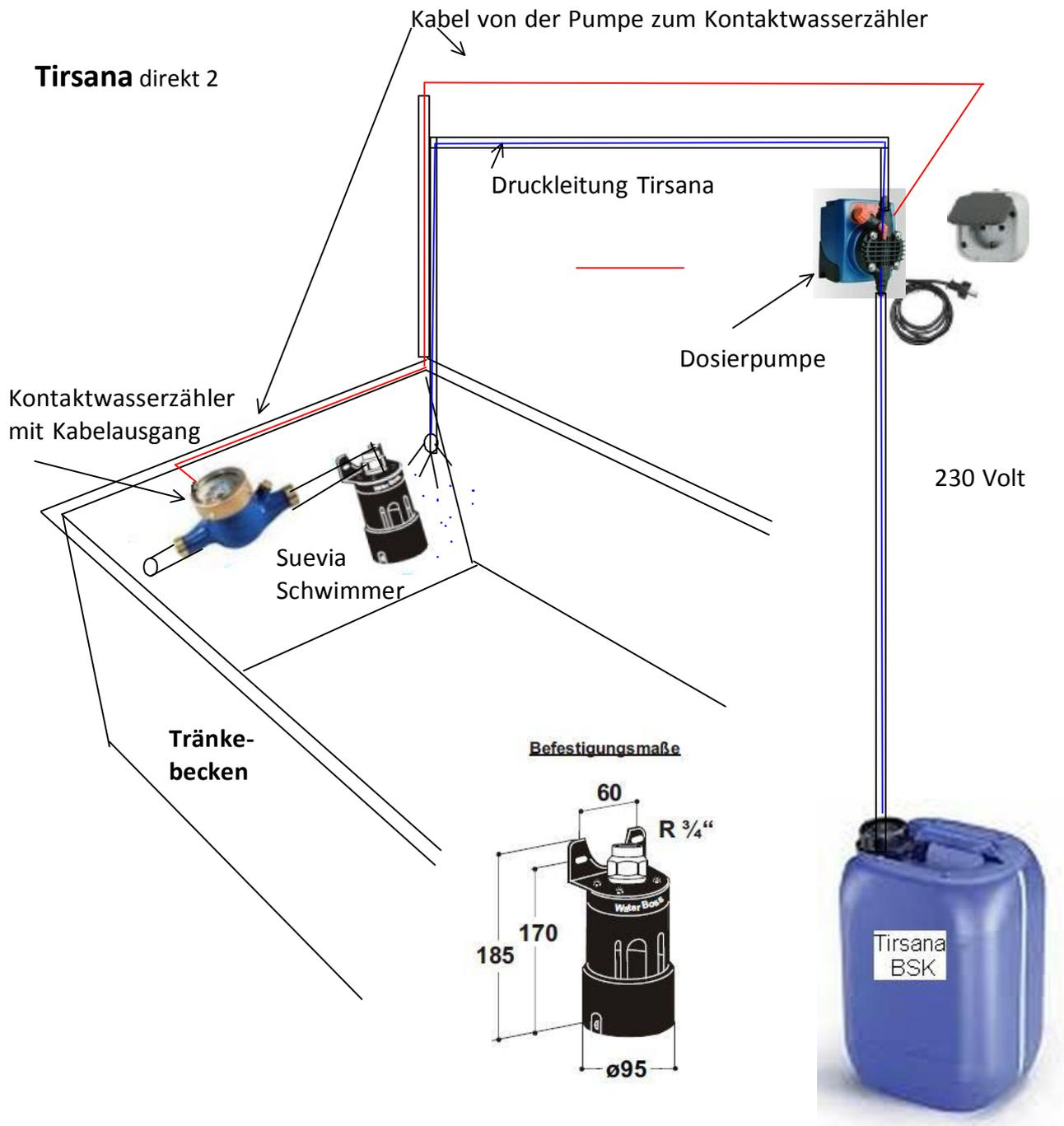
Druckleitung Tirsana und Kabel vom Kontaktwasserzähler müssen so verlegt werden, daß die Tiere diese nicht beschädigen.
